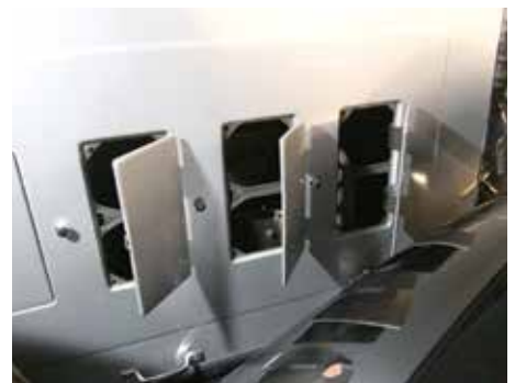
Mootori paremaks jahutamiseks saab katte külgedel avada väikesed luugikesed.
